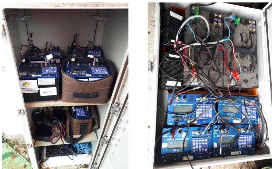
Photo 21 : exemples d'installations de récepteur-enregistreurs utilisés pour la détection des smolts sur l'Ariège.
