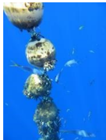
Fouling sur les flotteurs (source : PNMM)
