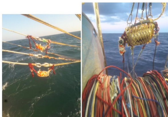
Figure 1 : Les pingers testés en action de pêche (Rimaud et al., 2019) Figure 2 : Positionnement des pingers lors de l'opération de pêche (Rimaud et al., 2019)
