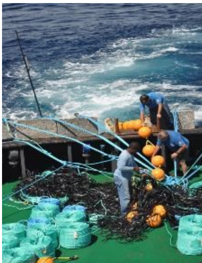
Mise à l'eau de DCPa (source : PNMM)
