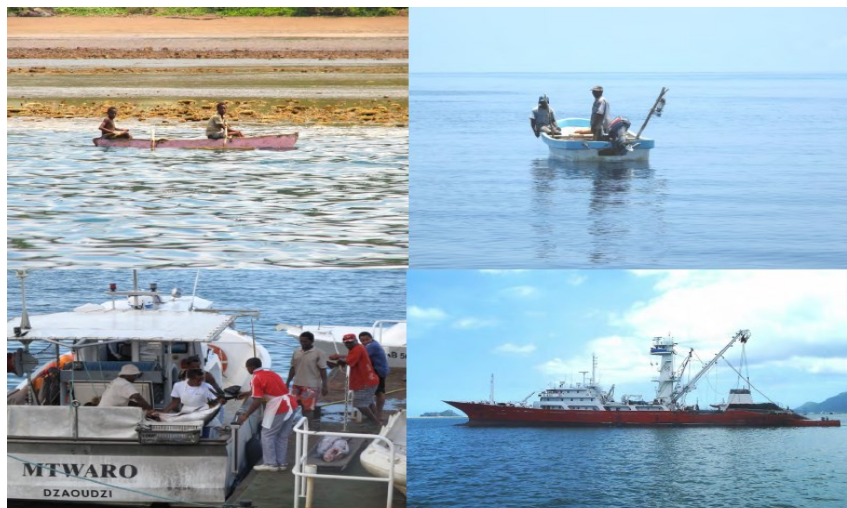
Les différentes embarcations présentes dans la ZEE de Mayotte : des pêcheurs en pirogue (en haut à gauche), des pêcheurs en barque « Yamaha » (en haut à droite), un palangrier côtier (en bas à gauche), un thonier senneur hauturier (en bas à droite)
