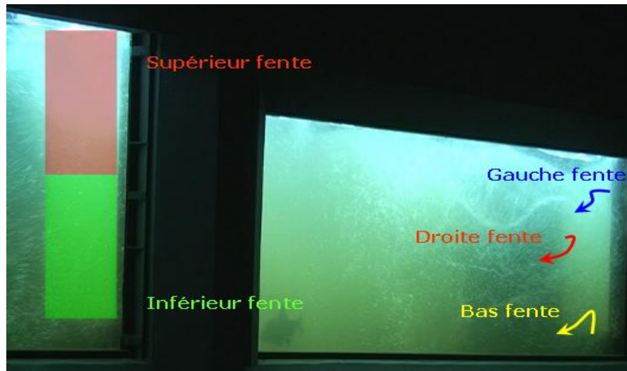
Figure 7 : Codification utilisée lors du passage d'un poisson dans une fente du bassin.
