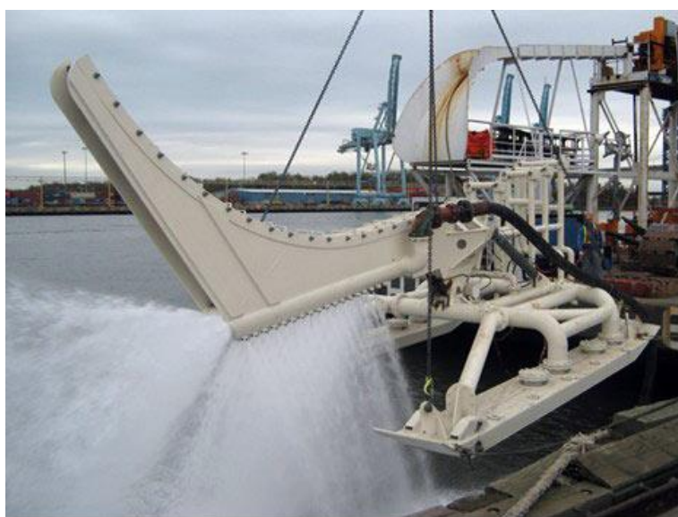
Figure 24 : Charrue à jet d'eau (© RTE)
