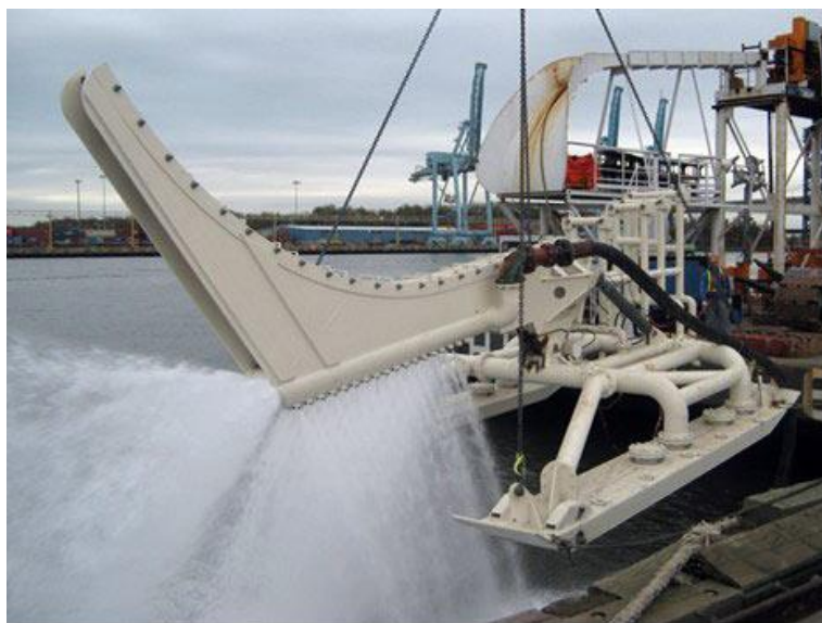
Figure 24 : Charrue à jet d'eau (© RTE)
