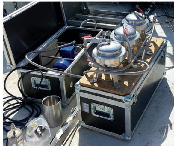
Figure 6. Système de filtration
